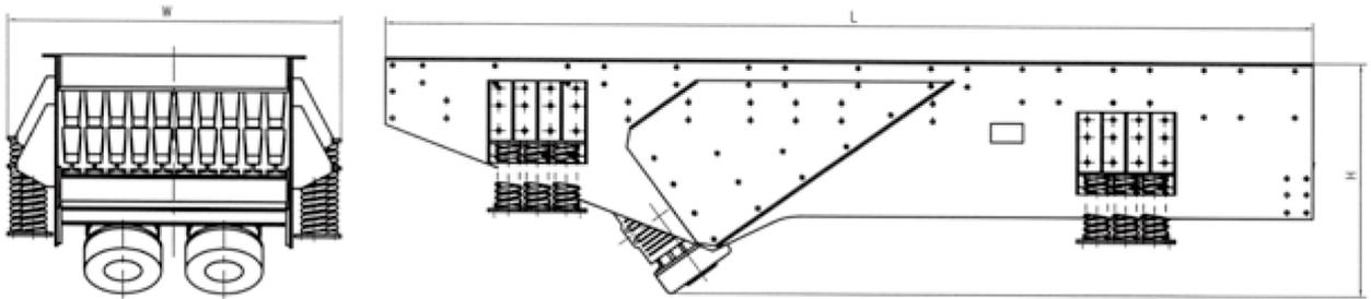
GZT系列振动给料机系消化吸收瑞典技术设计制造，并采用引进日本技术生产的振动电机为激振源。该系列给料机用于粗碎破碎机前大块物料的均匀给料，同时由于棒条筛面的作用，能除掉泥土等细碎物料，达到预筛分功能，提高粗碎能力。特别适用于水电行业、建筑石料、金属矿石等粗碎前的给料用。
